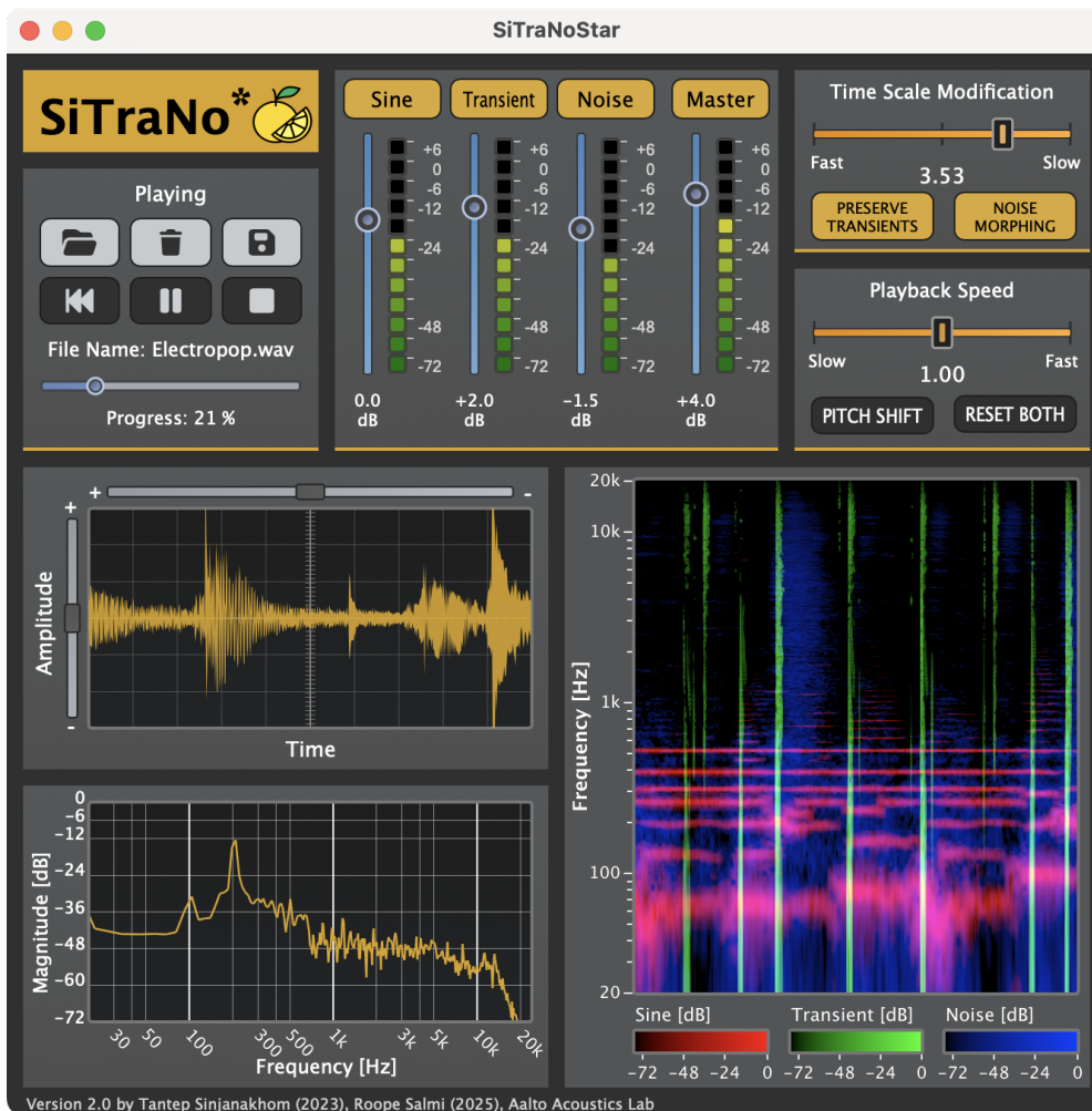
Kuva 2: SiTraNo*-sovelluksen käyttöliittymä, jossa on valittu tiedosto ‘Electropop.wav’. Liikusäädöt osoittavat, että transientteja vahvistetaan 2 dB ja kohinaa vaimennetaan 1.5 dB. Venytykseksi on valittu 3.53-kertainen hidastus (yläoik.). Näytön alaosassa piirretään käsitellyn äänen aaltomuoto (kesk. vas.), hetkellinen magnitudispektri (alavas.) ja spektrogrammi (alaoik.), missä äänen kolme komponenttia näytetään eri väreillä.
