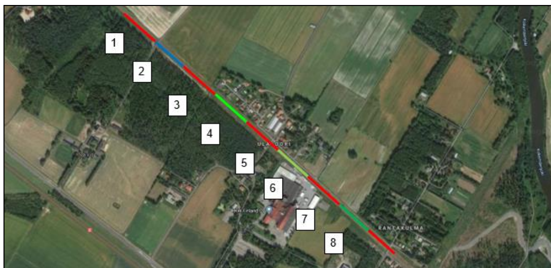
Kuva 1. Mittauslinjat (ML) 1-8 koeradalla. Punaisella merkityt osuudet (1, 3, 5 ja 7) ovat referenssiratana toimineita betonipölkkyosuuksia. Sininen (2) on pohjainpölkkyosuus ja vihreät (4, 6 ja 8) erilaisia synteettisellä pölkkyllä toteutettuja osuuksia. Synteettiset pölkkyt olivat mitoiltaan 35/16 cm, 30/16 cm ja 26/16 cm.
