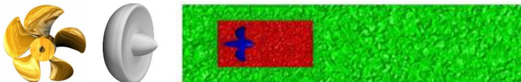
Kuva 1: PPTC esimerkkipotkuri vasemmalla ja potkurin sisään sulkeva konforminen pinta keskellä. Potkurin halkaisija on 25 mm. Oikealla: leikkaus kavitaatiotunnelifluidin akustisesta elementtimallista.
