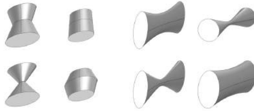
Kuva 7. Alkeiselementtejä, vasemmalla kartiotyypisiä, oikealla hyperbolisia.
