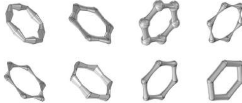
Kuva 8. Korkeamman asteen elementtejä, vasemmalla kartioelementtipohjaisia, oikealla hyperbelielementtipohjaisia.
