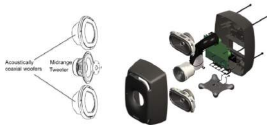
Kuva 5. Akustisesti koaksiaalisen kolmitiekaiuttimen rakenne
