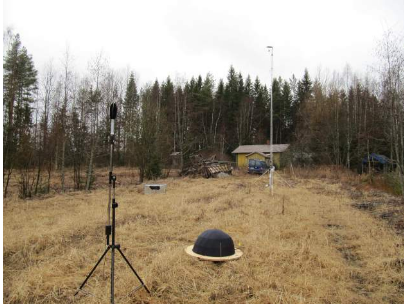
Kuva 2: Siikaisten immissiomittauspiste. Samanlainen mittausjärjestely oli jokaisella mittauspisteellä ja lisäksi mikrobarometri emissiomittauspisteillä.
