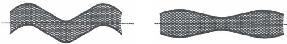
Kuva 1. Antisymmetrisen aalto (vasen) ja symmetrisen aalto (oikea) sandwich-levyssä.
