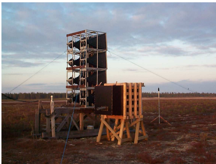
Kuva 1: Äänilähde Sodankylän lentokentällä. Etualalla bassokaiutinta varten rakennettu sääsuoja telineen päällä ja takana 4 metriä korkea torviasetelma. Päällystetty kiitotie on kaiuttimien takana. Kaiutinten edessä mikrofoni automaattikalibrointia varten.
