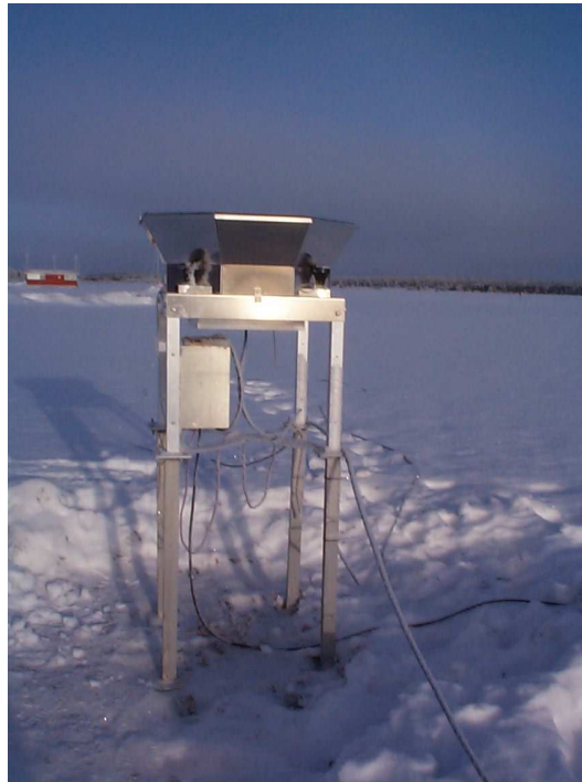
Kuva 3: Doppler-SODAR mittaa ilmakehän ominaisuuksia äänilähteen lähellä lentokentällä.
