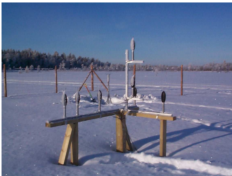
Kuva 2: Akustinen antenni maaliskuussa 2004. Taustalla näkyy juuri asennettu akustinen anemometri.
