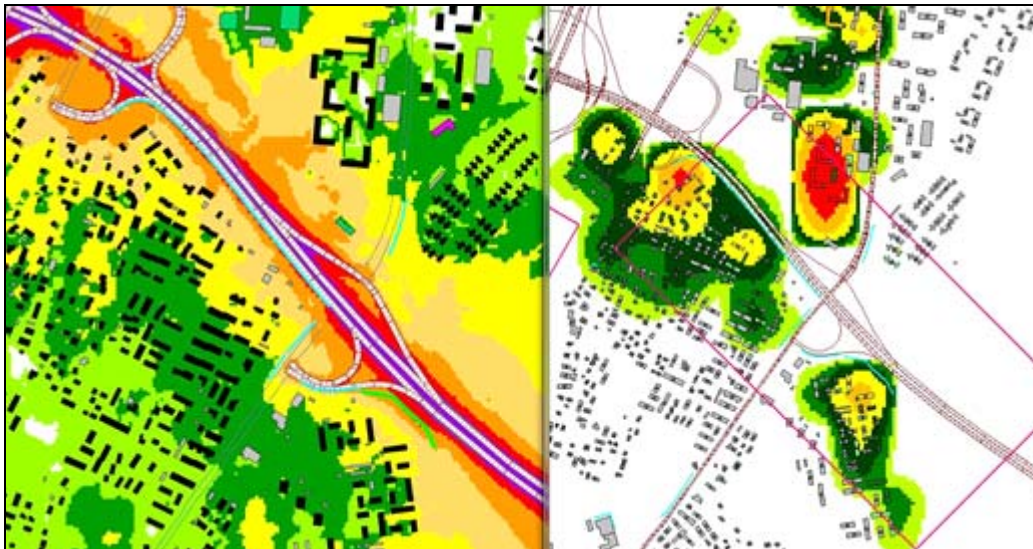
Kuva 1 vasemmalla puolella on perinteinen meluvyöhykekuva (keltainen 55 – 60 dB). Oikealla puolella on pisteytysmenetelmällä muodostetut ”kuumat” (hotspot) kohteet.
