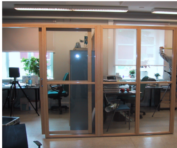
Kuva 3 - RASTI-mittaus työpisteiden välillä. Kaiuttimen ja mikrofonin etäisyydet lattiaan ja seinäkkeeseen olivat 1.2 metriä.
