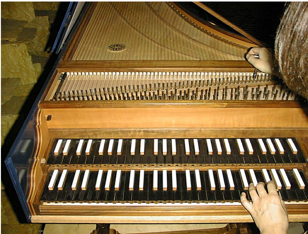
Kuva 1. Tutkimuksessa käytetyssä cembalossa on kaksi koskettimistoa, kolme äänikertaa ja kaksi kielisiltaa. Tässä kuvassa soitinta viritetään TKK:n isossa kaiuttomassa huoneessa.
