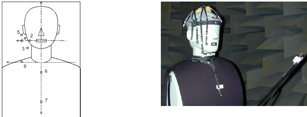
Kuva 2. Mittapisteet ja mittaustilanne keinopäälle. Kuvassa mittauksissa käytetty B&K 4128 C sekä Sennheiserin elektreettimikrofonit taulukossa 1 esitetyissä mittapisteissä.
