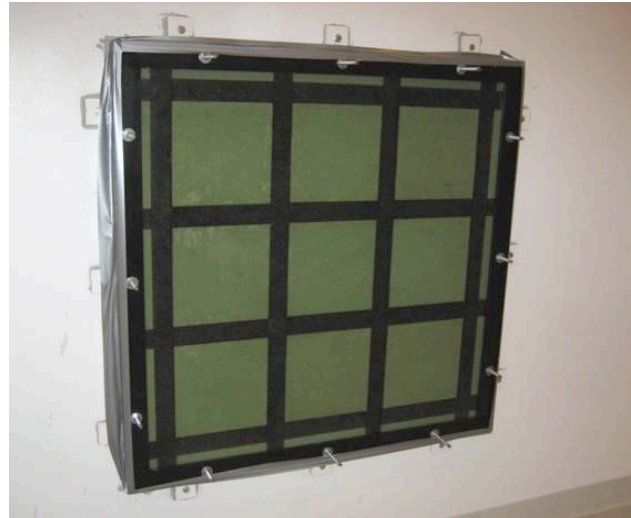
Kuva 4. Tutkitut jaksolliset paneelit: vasemmalla kirjoittajista Aalto raitapaneelin kanssa, oikealla ruutupaneeli asennettuna kaiuntahuoneen mittausaukkoon ääneneristävyyden mittausta varten.
