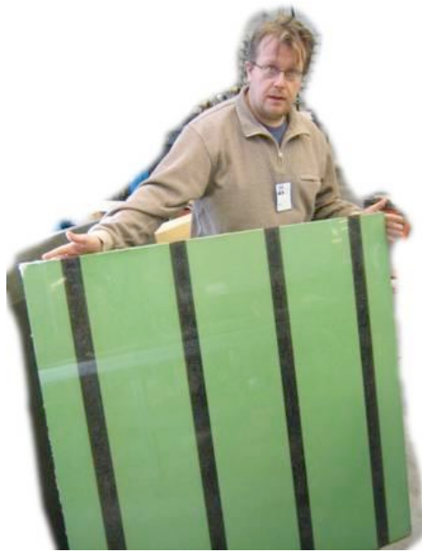
Kuva 4. Tutkitut jaksolliset paneelit: vasemmalla kirjoittajista Aalto raitapaneelin kanssa, oikealla ruutupaneeli asennettuna kaiuntahuoneen mittausaukkoon ääneneristävyyden mittausta varten.
