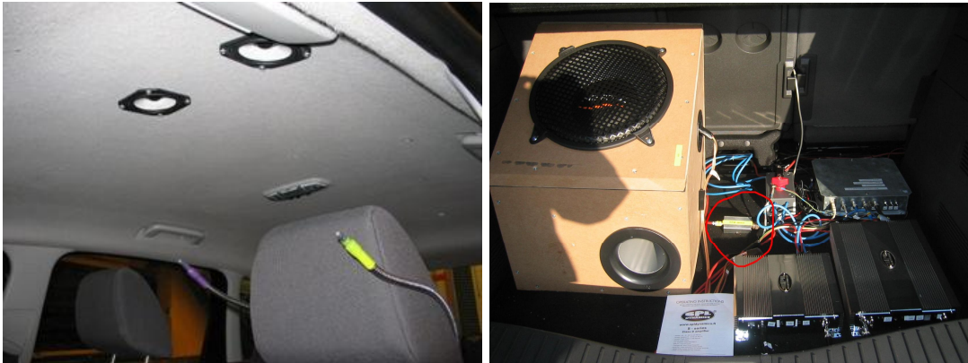
Kuva 5. Virhemikrofonit ja keskiaänikaiuttimet (vasemmalla) sekä takaluukussa sijaitsevat säätöelektronikka, bassokaiutin ja vahvistimet (oikealla).
