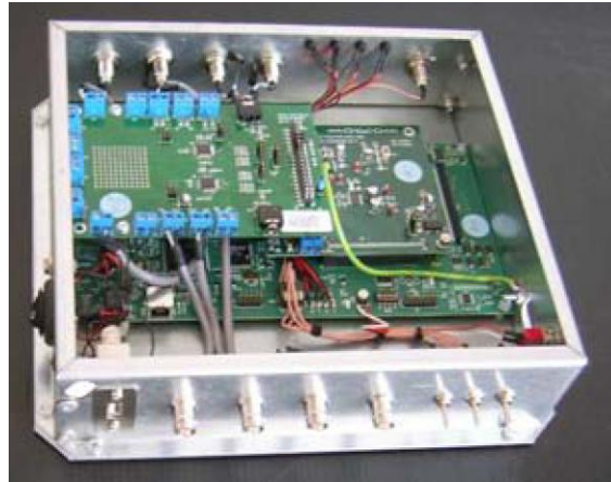
Kuva 7. Autoa varten tehty ANP-säätöjärjestelmä, jossa näkyvät mikrofonien ja muiden sensoreiden tuloliittimet, kaiutinsignaali- ja USB-liittimet sekä USB PC-liityntä [4].
