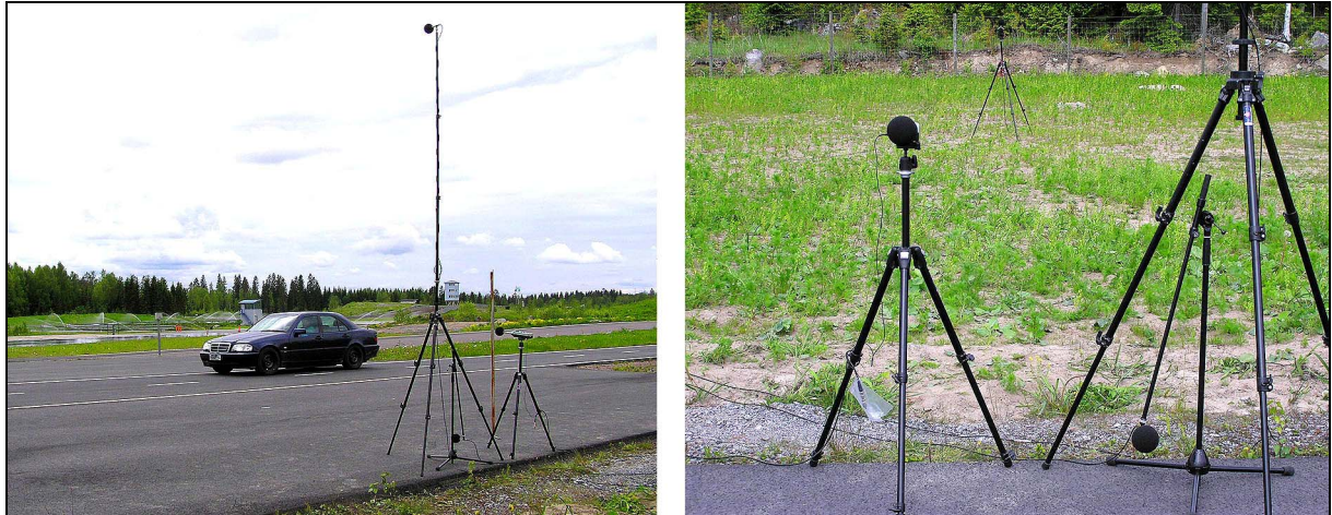
Kuva 1. Mikrofonit Nokian Renkaiden koeradalla.
