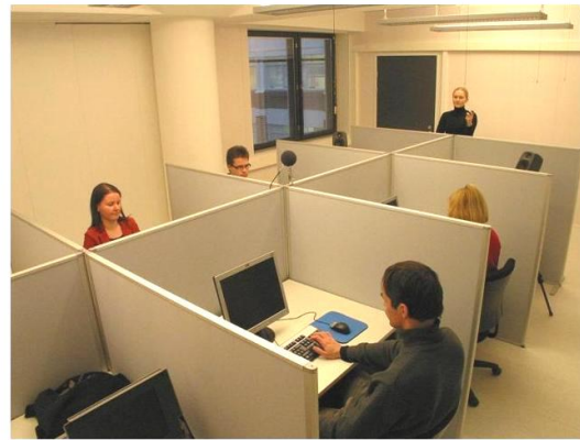
Kuva 1. Laboratorion pohjakuva ja valokuva. Puhe tuotettiin tyhjiin työpisteisiin sijoitetuista kaiuttimista (S1-S4). Peiteääni tuotettiin alakattoon piilotetuista kaiuttimista (M1-M5).
