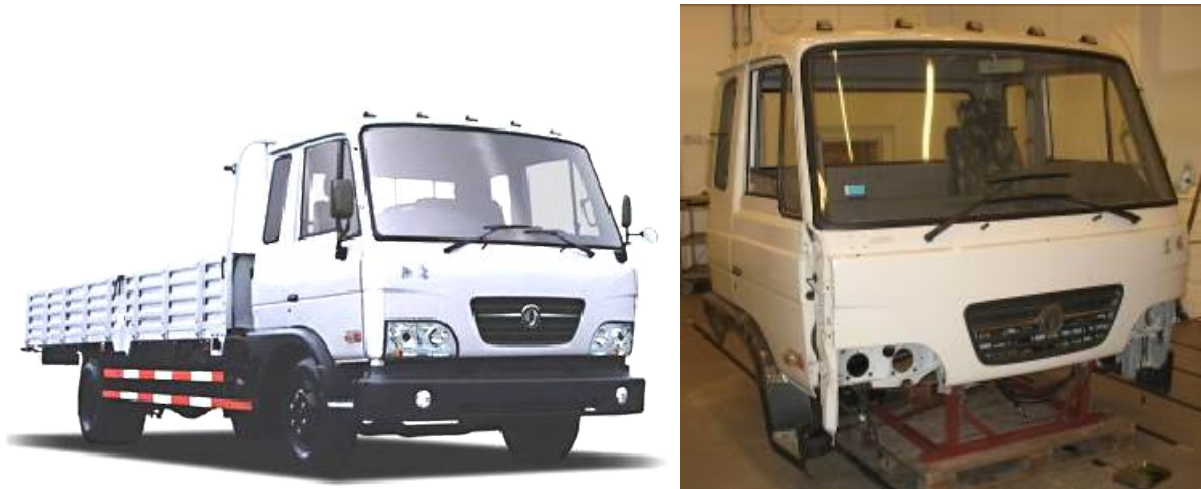
Kuva 1. Dongfeng Motor Co:n kuorma-auto, johon kokeilujärjestelmä rakennettiin ja sen ohjaamo VTT:n aktiivisen äänenhallinnan laboratorioissa valmiina mittauksiin ja kokeiluihin.
