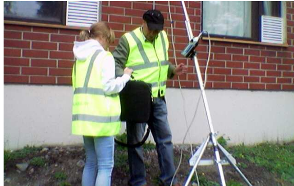
Kuva 1. Esimerkki melumittauksesta asuinrakennuksen julkisivun pinnalla.
