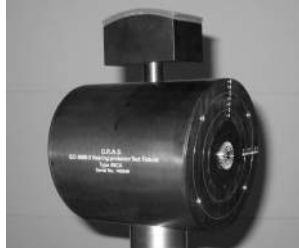
Kuva 2. Objektiiivissa kuulonsuojainmittauksissa käytettävä keinopää (ATF, acoustic test fixture)
