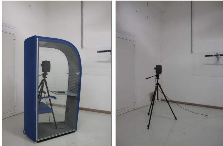
Kuva 1. Työpistekokonaisuuden äänenvaimennusmittauksen vaiheet: vasemmalla mitaus puhelinkopin #6 kanssa ja oikealla mitaus ilman puhelinkoppia. Mikrofoni ei näy kuvassa.
