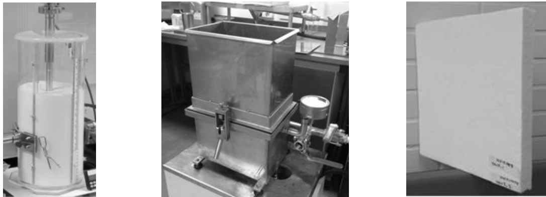
Kuva 1. Vasemmalla on vesikuituvaahdon valmistusastia, keskellä muotti vaahtorakenteiden tekemiseen laboratoriomittakaavassa ja oikealla valmis havuselluloosasta valmistettu äänenabsorptiopaneeli.
