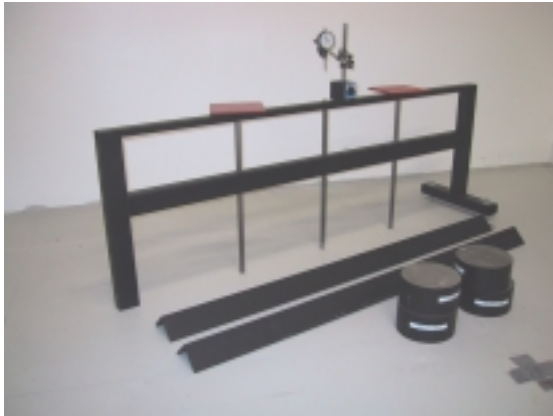
Kuva 1. Taivutuslaite muodostuu kahdesta tuesta (1), kuormitustelineen kehikosta (2), punnuksista (3), mittasauvasta (4) ja kahdesta voimatangosta (5).
