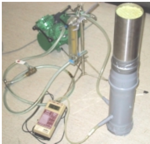
Kuva 2. Vasemmalla on mineraalivillan virtausresistiivisyyden ja oikealla huokoisen materiaalin rakennetekijän määrittämisessä käytetty laitteisto.
