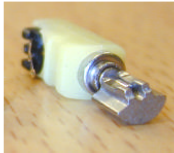
Kuva 2. Värinäkomponentti: sähkömoottori ja epäkesko.
