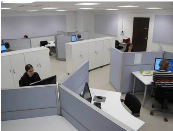
Kuva 2. Avotoimistolaboratorio. Valokuvassa sermikorkeus on 130 cm (äänitilanne 1). Puheäänikaiuttimet sijaitsivat nurkkatyöpisteissä 120 cm korkeudella.
