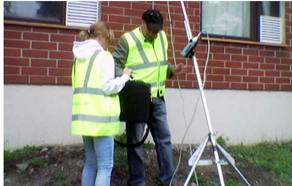
Kuva 1. Esimerkki melumittauksesta asuinrakennuksen julkisivun pinnalla.
